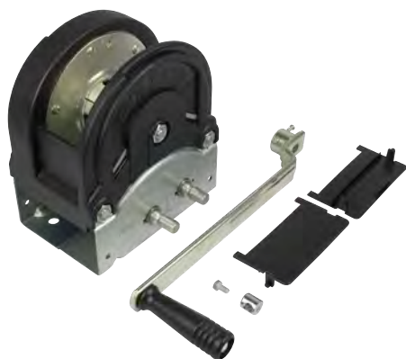
Handseilwinde, Typ TPV1600 für Autotransporter automatische Lastdruckbremse ohne Trommelfreilauf ohne Seil Kurbel abnehmbar
