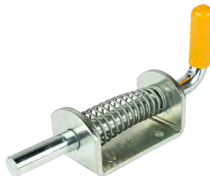
Federriegel zum Anschrauben, verzinkt, ohne Arretierung Bohrungs-Ø 6,5 mm, Bolzen-Ø 12 mm, Hub 22 mm
