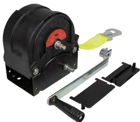
Handseilwinde, Typ TS900 für Bootstrailer (1-Gang-Getriebe) mit patentiertem Sicherheitssystem ohne Trommelfreilauf inkl. Gurtband und Haken Kurbel abnehmbar
