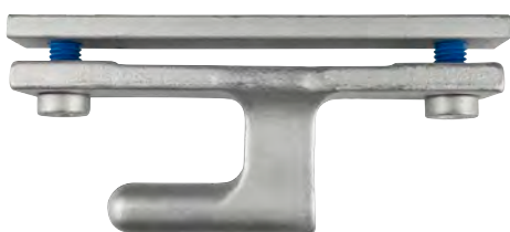
Scharnierbolzen mit Gewindeplatte, 2 Schrauben mit Polyfleck Werkstoff: C1045, Oberfläche: Dacromet 500 für Humbaur
