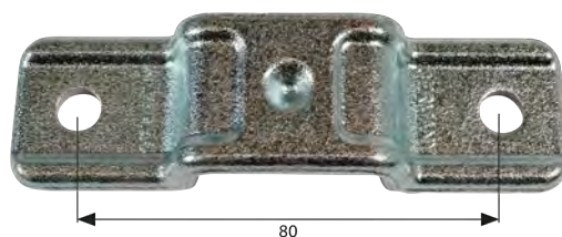
Rungenhalter für Rungen 10 x 30 mm Bohrungs-Ø 8 / 5 mm, Stärke 6 mm
