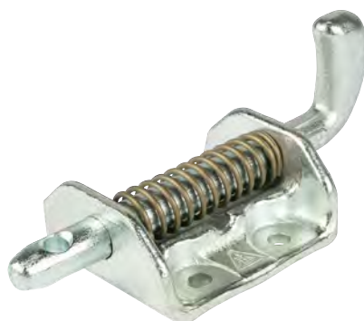
Federriegel zum Anschrauben, verzinkt, arretierbar Bohrungs-Ø 6,5 mm, Bolzen-Ø 12 mm, Hub 24 mm
