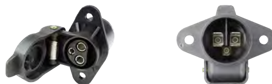
Steckdose 3-pol., 12 - 24 V Kunststoff, Flachsteckanschluss robuste Ausführung, vernickelte Kontakte für Winterdienstfahrzeuge und Landwirtschaft nach DIN 9680
