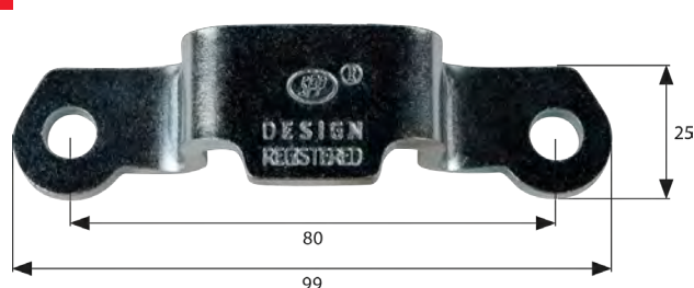
Gegenhalter für Spannverschluss zum Anschrauben, verzinkt Bohrungs-Ø 8,5 mm, Stärke 4 mm
