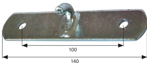
Gegenhalter für Spannverschluss zum Anschrauben, verzinkt Bohrungs-Ø 8,5 mm, Haken-Ø 8 mm
