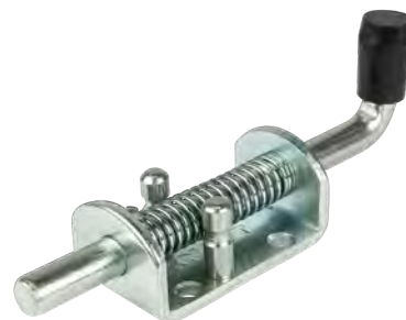
Federriegel zum Anschrauben, mit Arretierung, Grundplatte 75 x 40 mm Bohrungs-Ø 6 mm, Bolzen-Ø 12 mm, Hub 15 mm
