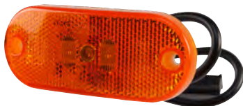
Seitenmarkierungsleuchte Jokon LED, gelb 12 V, Kabellänge 500 mm Maße (mm): 110 x 45 x 18
