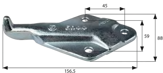
Gegenhalter für Excenterverschluss zum Anschrauben, verzinkt Bohrungs-Ø 8,8 mm, Haken-Ø 11,5 mm
