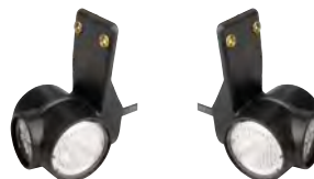
Begrenzungsleuchte Aspöck Superpoint III LED, rot / weiß / gelb gerade, mit Pendelhalter 12 V, Kabellänge 1000 mm, Länge 104,8 mm
