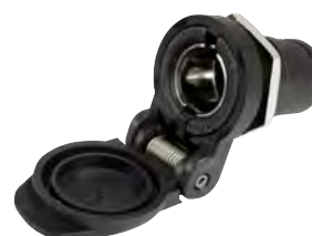
Steckdose 2-pol., 6 - 24 V, Zigarettanzünder Flachsteckanschluss mit Schnappdeckel max. 16 A, Gewinde M18 x 1 nach ISO 4165
