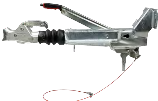
Auflaufeinrichtung AL-KO für V-Deichsel mit Stützradkonsole
