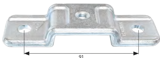
Rungenhalter verzinkt, ohne Schraube für Rungen 10 x 40 mm Bohrungs-Ø 10 mm, Stärke 7 mm
