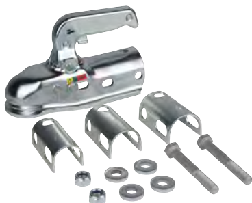
Kugelkupplung SPP BC-3000.1D inkl. Reduzierstücke, Schraubmaterial
