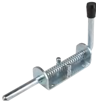
Federriegel zum Anschrauben, verzinkt, mit Arretierung Bohrungs-Ø 6,5 mm, Bolzen-Ø 12 mm, Hub 56 mm
